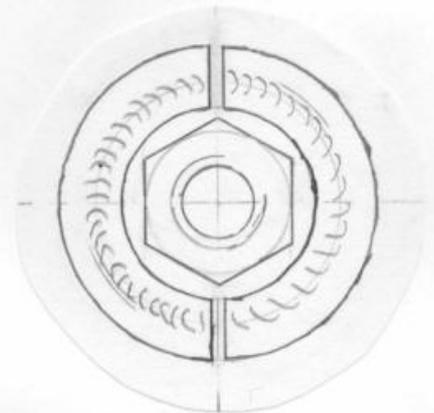
Als Gegenlager wird an eine kräftige Beilagscheibe mit 30 mm Außendurchmesser eine Mutter angeschweißt. Das Gewinde der Mutter sollte zu einer Abzieher-spindel mit gelagerter Spitze passen. Die Beilagscheibe stützt sich nun am hinteren Rand der Halbschalen ab. Zur Schonung des wichtigen Zapfens habe ich mir eine Büchse mit 8,1 mm Innendurchmesser und 10 mm Tiefe angefertigt, auf der sich die Spindelspitze abstützen kann.
