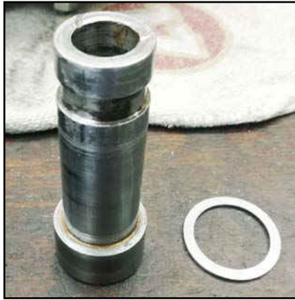
Eine Schraube im Inneren der Bremse musste gekürzt werden.
